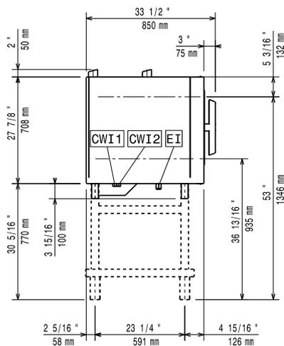
CWI1 = Kaltwasserzulauf                      EI = Elektroanschluss
